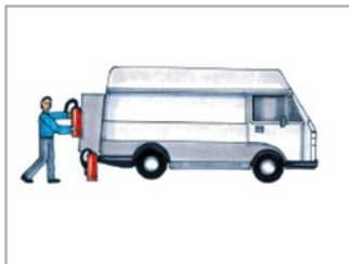
Eingesetzte Feuerlöcher nicht mehr aufhängen, Feuerlöcher neu füllen lassen
